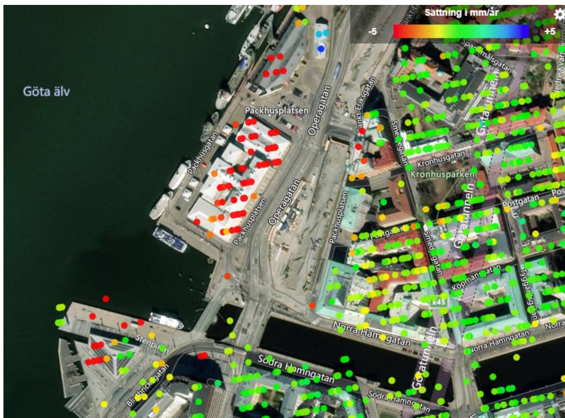
Figur 39. Kartbild med färgkodade punkter visande storleken för pågående sättningar inom Packhuskajen, skala från -5 till +5 mm/år. Den beräknade rörelsehastigheten baseras på punkternas sättningsrörelser under perioden mars 2017 till mars 2021. Hämtad från www.sättningskartan.se 2023-09-11.
