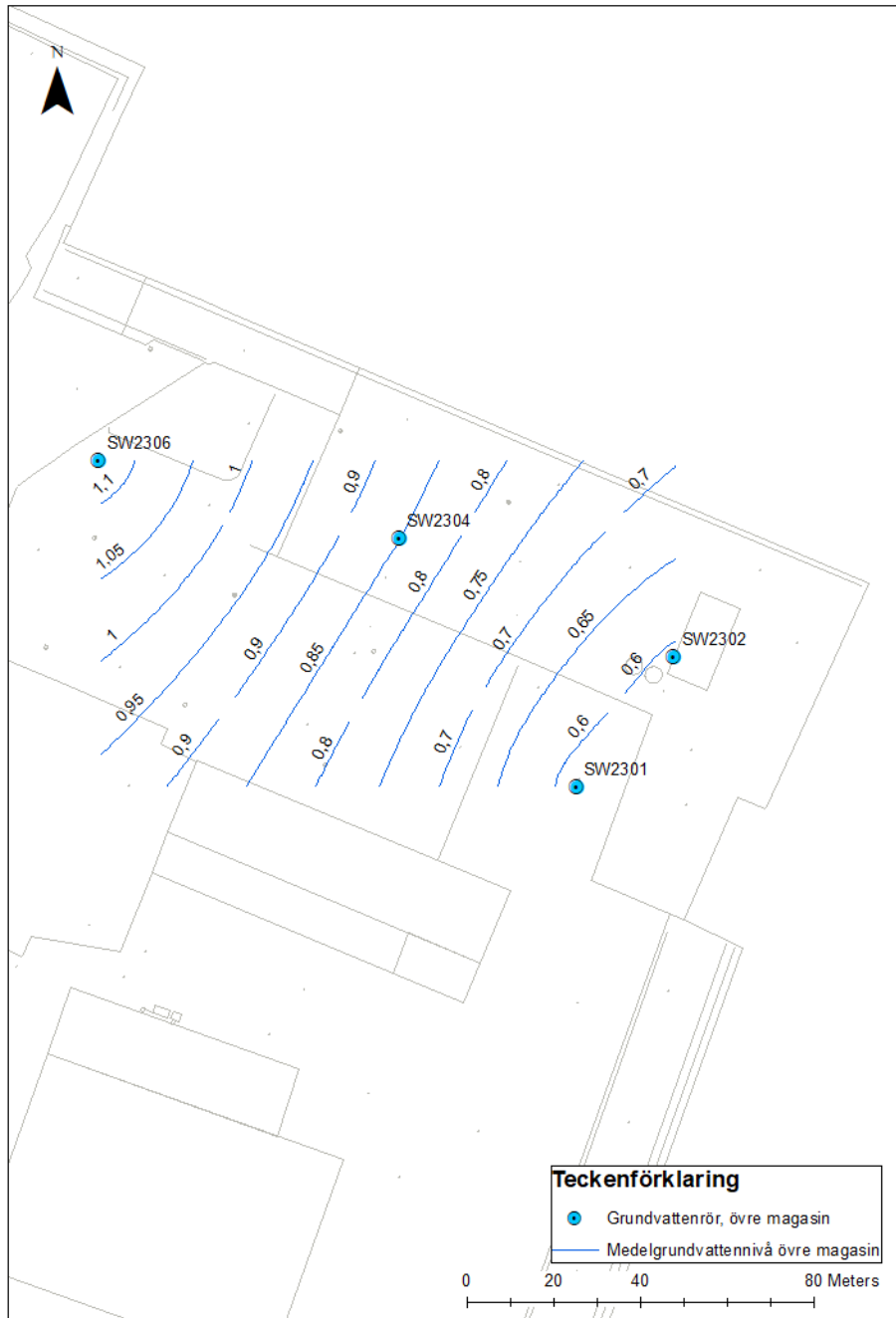
Figur 17. Kartbild med grundvattenrör på Hugo Hammars kaj i övre magasin och interpolerad medelgrundvattennivå i övre magasin baserat på mätningar utförda november 2023 till januari 2025
